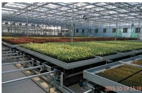
**主要内容与效果：**项目是当前国内唯一实现全程智能化生产的种苗工厂，应用了我院设施所研究开发的智能物流栽培系统，集成了潮汐灌溉技术，实现了温室生产真正的流程化和工厂化，综合技术达到与荷兰同步的水平。
