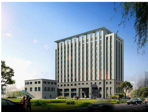
程建筑面积 13011 平方米，地下 1 层，地上 11 层，檐口高度 44.95 米。抗震设防裂度 8 度，结构形式为全现浇框架—剪力墙结构，基础采用梁板式筏形基础。
