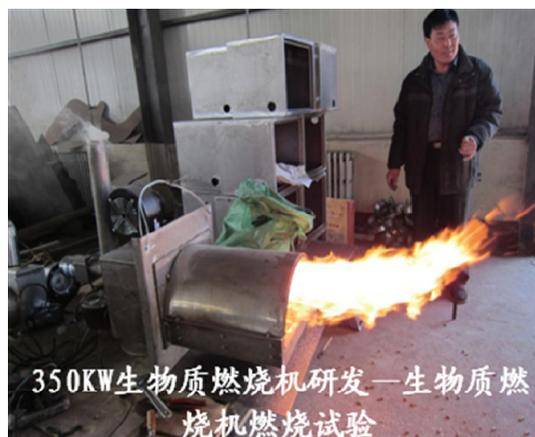
了 5 种模块，开展磨损试验；在燃烧实验室搭建了燃烧试验数据采集平台，测试多种生物质颗粒燃料的燃烧特性和燃烧器的性能特性；设计了新型抗结渣机构，研究开发 350KW 生物质燃烧机，并开展燃烧试验。
