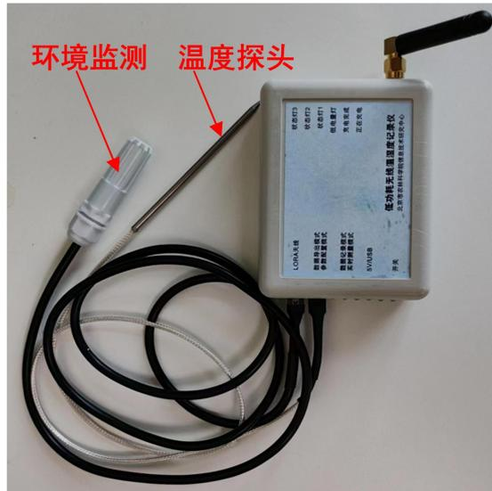
图 3 探针式温度传感器
